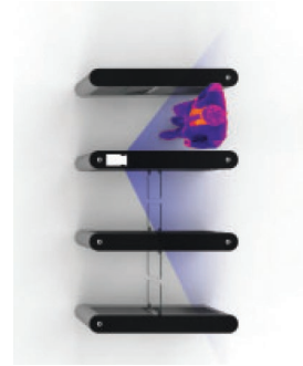
Тепловизионная камера установлена на верхней панели скоростного турникета EasyGate
